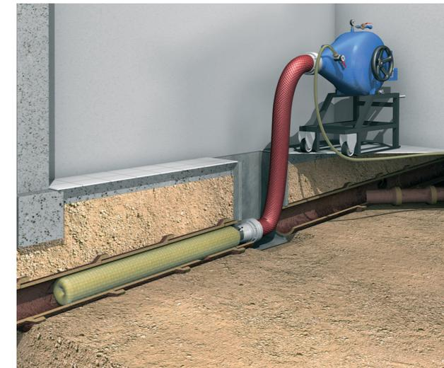
wand gepresst und ausgehärtet (Bild oben). Der Schlauchliner dichtet das Rohr auf der gesamten Länge ab, ohne Muffen und Übergänge (Bild links). Das Verfahren hat enge Anwendungsgrenzen: So können z. B. große Lageveränderungen, starke Muffenversätze oder starke Scherbenbildung damit nicht behoben werden. Kleinere Muffenversätze oder eingewachsene Wurzeln müssen vor dem Einbringen des Liners mit einer Fräse entfernt werden.
