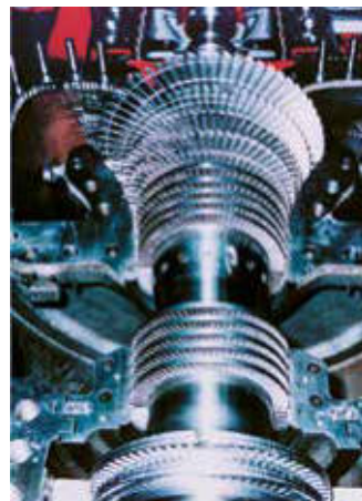
50 Prozent des Eigenbedarfs an Strom für die ARA und SEVA in Sindlingen erzeugt die Dampfturbine (Blick in offene Maschine).
