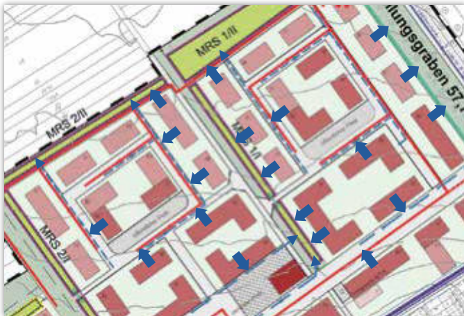
Der Planausschnitt zeigt die Richtung der Ableitung (blaue Pfeile) in flache Regenwasserkanäle (gestrichelte Linien) zur Versickerung in Mulden-Rigolen-Systeme (MRS) in den öffentlichen Grünflächen (Plan: UBS GmbH für SEF, 2019)
