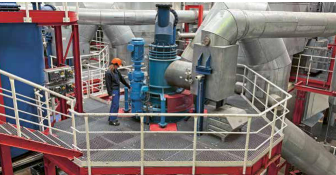
Am Ofenkopf befindet sich neben der Schlammaufgabe der Antrieb für die Drehung der Hohlwelle und der Rührarme der Trockenetagen.
