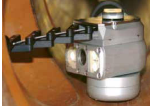
Kamera beim Abbiegen in einen Seitenkanal
