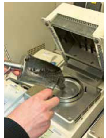
Bestimmung des Trockengehalts des Klärschlammes mit der Trocknungswaage.
