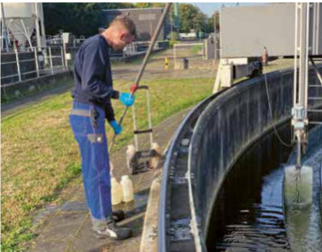
Die Abwasserproben werden vor Ort entnommen und im Labor auf relevante Inhaltsstoffe geprüft.
