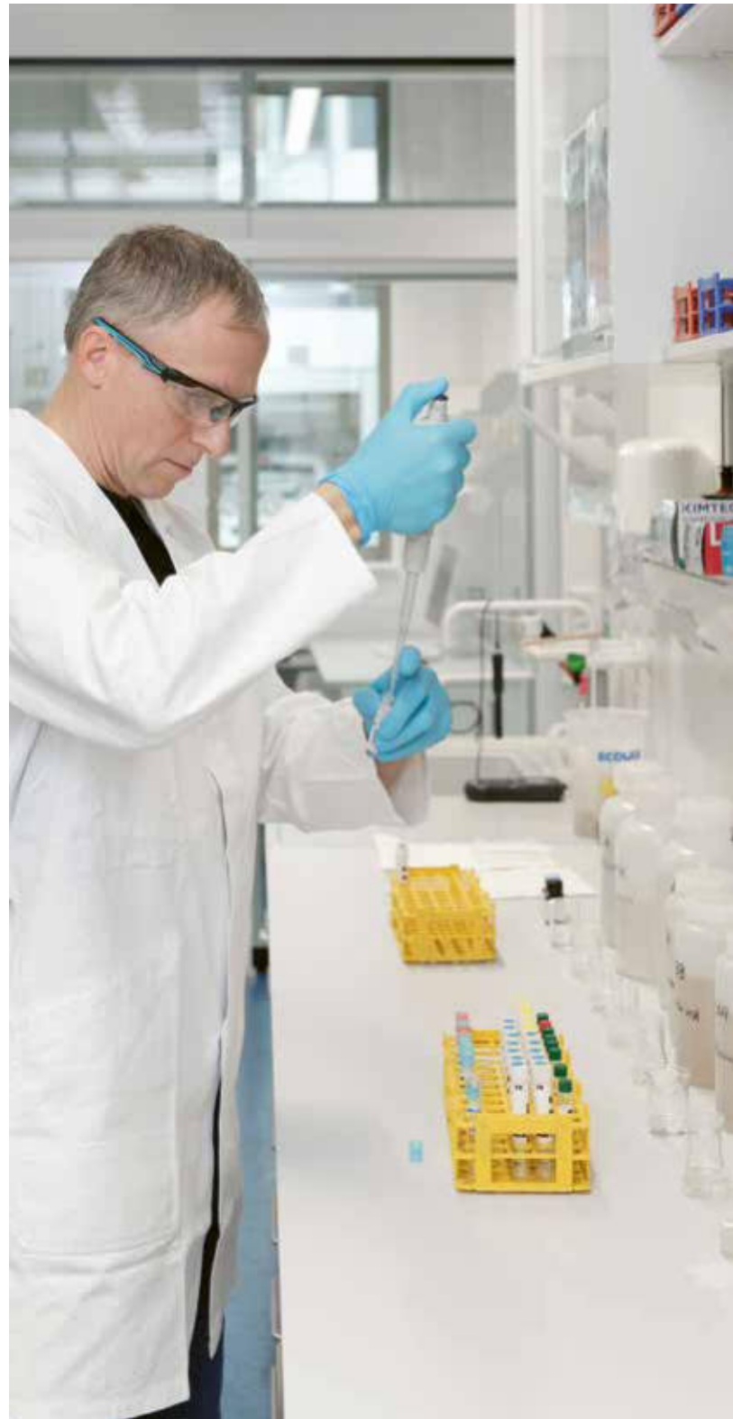
Die Abwasserproben werden vor Ort entnommen und im Labor auf relevante Inhaltsstoffe geprüft.
